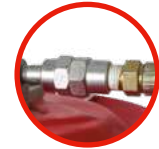
CONEXIÓN GIRATORIA DE MANGUERA A ENGRASADOR PARA EVITAR QUE LA MANGUERA SE TUEZA
