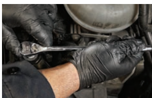
Empuñadura extendida de alto apalancamiento
