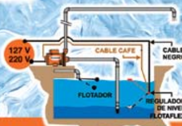
INSTALACIÓN TIPO C Bomba / Cisterna
